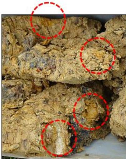
Au cours des inventaires du 23 mars 2023, les sondages n°7, 11, 12 et 13 présentaient, à partir d'une profondeur d'environ 20 cm, des traces d'oxydation (voir photo ci-contre).
